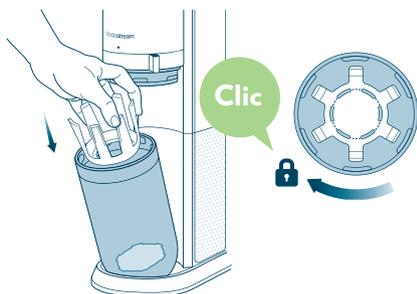
**4** Remplacez le support à bouteille en tournant dans le sens des aiguilles d'une montre
