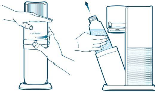
**3** Pour déverrouiller, tourner le levier vers la droite et le bloc de gazéification se soulèvera automatiquement
