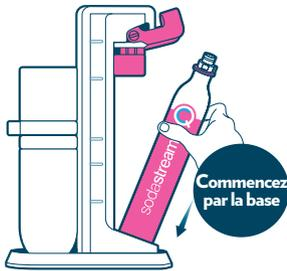
**4** Insérez la base du cylindre\* dans l'appareil
