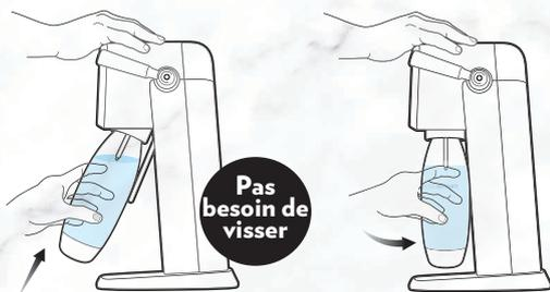
**3** Insérez la bouteille dans l'appareil et poussez pour **ramener** la bouteille en **position verticale**
