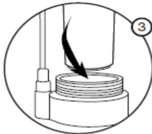
Coloque la nueva unidad filtrante encastrándola en el centro de la base del dispositivo. No presione al insertarla.
