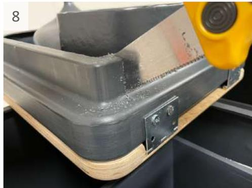
8 Vergrößerung der Öffnung am hinteren Rand, um Unterlegscheiben und Muttern leichter von innen befestigen zu können.
