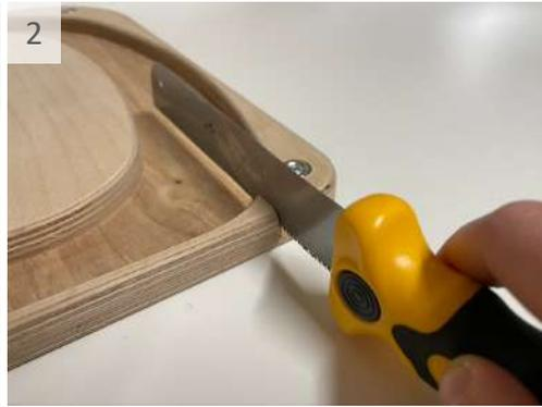
2 Säge zunächst zwei Kerben in die Innenseite des Holzdeckels. Achte darauf, dass du die Säge möglichst horizontal führst.
