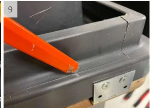
9 Dazu erst mit der Säge vertikal, auf Höhe des Scharniers hineinsägen und horizontal mit dem Teppichmesser heraustrennen.
