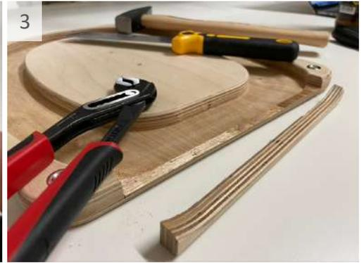
3 Setze die Kerben so, dass du ausreichend Platz für dein Scharnier erhältst. Den Steg kannst Du mit der Zange herauslösen.
