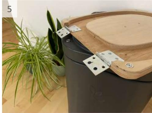
5 Die Position vom Scharnier so wählen, dass der Deckel im gewünschten Winkel stehen bleibt. Dann erst das Scharnier fixieren.
