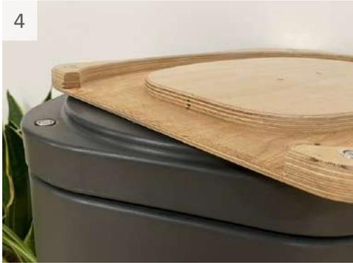
4 Abschließend die Kerbe sauber mit einer Holzfeile nachbearbeiten. Tipp: Lege die Scharniere auf und teste die Position.
