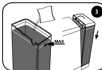
Vul het reservoir met vers water tot het maximumniveau en laat de ontkalkingsoplossing oplossen.
