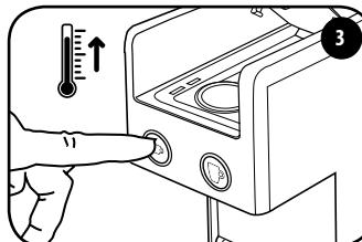
Die Taste drücken, um die Temperatur zu erhöhen. Die Taste blinkt. Nach ca. 3 Sekunden blinken beide Tasten.
