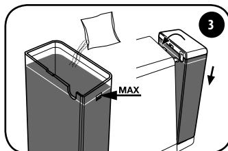
املاً الخزان بالماء العذب إلى الحد الأقصى وقم بإذابة محلول إزالة التربات. أعد إدخال الخزان وفقاً للشقين واصطحبه نحو الماكينة حتى يتم تثبيته بالكامل.
