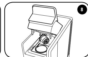
Per espellere la capsula usata alzare lentamente la leva e la capsula verrà automaticamente raccolta nell'apposito contenitore. Se la capsula non viene espulsa ripetere l'operazione.
