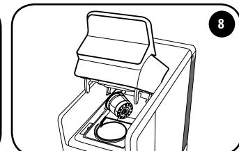
Um die leere Kapsel auszuwerfen, wird der Hebel langsam nach oben geschoben und die Kapsel automatisch in dem entsprechenden Behälter ausgeworfen. Wird die Kapsel nicht ausgeworfen, muss der Vorgang wiederholt werden.
