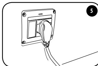
Die Maschine an die Steckdose anschließen.
