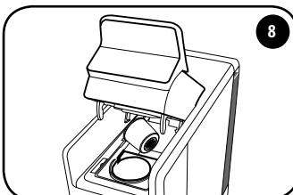
Til de hendel langzaam op om de gebruikte capsule uit te werpen. De capsule komt automatisch in de speciale verzamelbak terecht. Als de capsule niet wordt uitgeworpen, herhaalt u de handeling.
