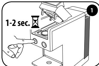
Bei geöffnetem Hebel die Maschine einschalten, indem man eine der beiden Kaffeeausgabestäbe 1-2 Sekunden lang drückt.
