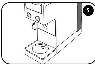
将杯架格栅置于垂直位置。在水箱中注入干净的饮用水。
