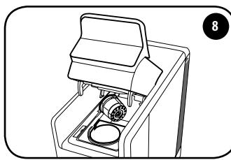
要排出已使用的咖啡胶囊时，需要缓慢抬起咖啡胶囊舱门，咖啡胶囊将自动收集在专门的容器中。如果咖啡胶囊没有排出，请重复该操作。
