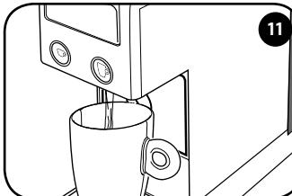
Tryk på en af tasterne ☕ eller ☕ og afvent at brygningen af varmt vand stopper. Maskinen er skyldet, når der er blevet brygget mindst 3 krus vand. Nu er maskinen klar til brug.
