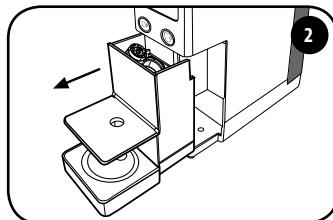
卸下咖啡胶囊回收托盘。咖啡胶囊回收托盘最多可容纳 7 个咖啡胶囊，因此建议定期将其清空以防止咖啡胶囊卡住。
