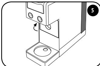
Porter la grille repose-tasses en position verticale. Remplir le réservoir d'eau potable fraîche.
