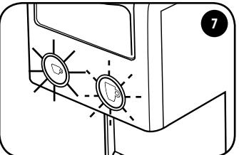
Nach Beendigung des Entkalkungszyklus leuchtet die Taste dauerhaft auf, während die Taste blinkt.
