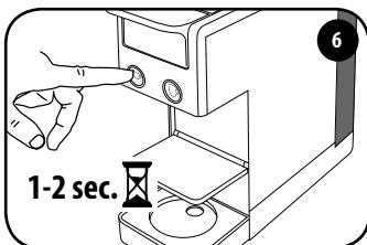
Schakel het apparaat in door 1-2 seconden op een van de twee koffieknoppen te drukken.
