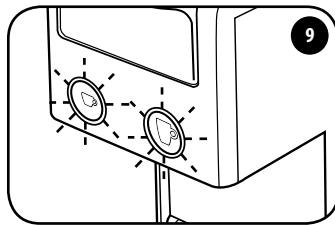
По завершении цикла ополаскивания кнопка и кнопка мигают одновременно.
