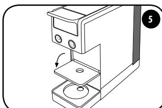
Abaisser la grille repose-tasses. Remplir le réservoir d'eau potable fraîche.
