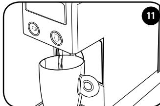
按下按钮 或 并等待，直到冲泡停止。冲泡至少 3 大杯水后，机器得到清洗。现在可以使用机器了。
