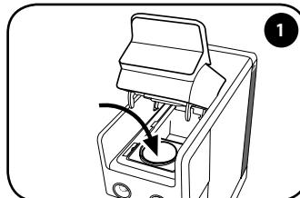
Eine Kapsel in die entsprechende Aufnahme einsetzen.
