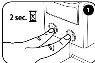
关闭机器，操作方式为：同时按住两个咖啡冲泡按键并保持2秒
