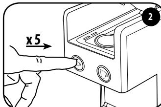
Innerhalb von 15 Sekunden nach dem Einschalten die Taste 5 Mal drücken. Beide Tasten blinken. Nun kann die Temperatur geändert werden, wie unter Punkt 3 und 4 beschrieben.
