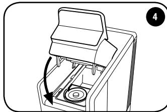
ارفع ببطء (حتى التوقف) ذراع فتح/غلق حجيرة الكبسولات. أدخل الكبسولات على النحو الموضح بالشكل. أعد غلق الذراع بالكامل.
