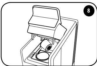
要排出已使用的咖啡胶囊时，需要缓慢抬起咖啡胶囊舱门，咖啡胶囊将自动收集在专门的容器中。如果咖啡胶囊没有排出，请重复该操作。
