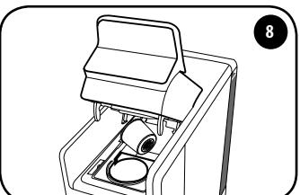
Para ejetar a cápsula utilizada, eleve lentamente a alavanca e a cápsula será coletada automaticamente no recipiente apropriado. Se a cápsula não for ejetada, repita a operação.
