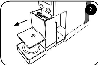
Den Auffangbehälter für leere Kapseln herausnehmen. Der Auffangbehälter für leere Kapseln fasst maximal 7 Kapseln, d.h. er sollte regelmäßig entleert werden, um zu vermeiden, dass die Kapseln verklemmen.
