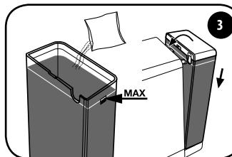
Remplir le réservoir d'eau fraîche jusqu'au niveau maximum et dissoudre la solution de détartrage.
