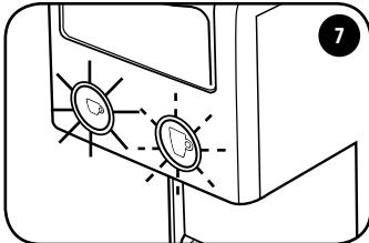
سيبدأ الجهاز في صب الماء. في نهاية دورة إزالة التربات الكلسية، يضيء الزر ⑥ بشكل ثابت، في حين يومض الزر ⑧. أزل الوعاء وأفرغه. أغسل الخزان جيداً وأملأه مجدداً بالماء العذب.
