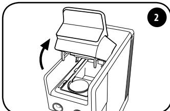
Levante lentamente (hasta el tope) la palanca de apertura y cierre del compartimiento de las cápsulas.
