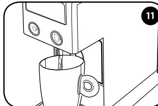
Druk op een toets of en wacht tot er geen water meer uit het apparaat stroomt. Het apparaat is goed gespoeld als er minstens 3 koppen water zijn afgegeven. Het apparaat is nu klaar voor gebruik.
