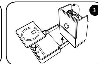
清空咖啡胶囊回收托盘并冲洗。清洁残余水和咖啡收集盘和格栅。清洁后，将收集盘与格栅重新钩接。
