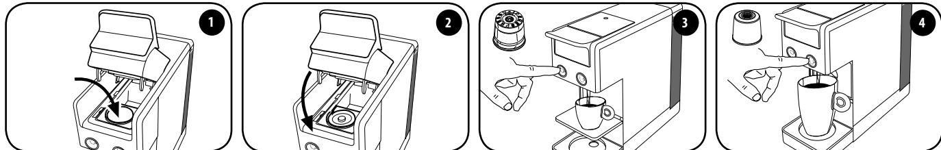
在专门的隔舱中插入一个咖啡胶囊。完全合上咖啡胶囊舱门。
