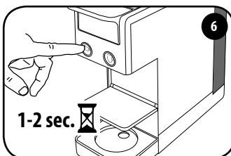
Включите машину, нажав на 1-2 сек. одну из двух кнопок подачи кофе.
