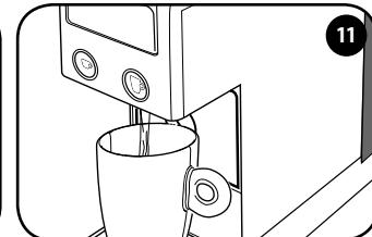
Appuyer sur la touche ou et attendre l'arrêt de la distribution d'eau. La machine est rinçée lorsqu'au moins 3 tasses d'eau ont été distribuées. La machine est désormais prête à l'usage.
