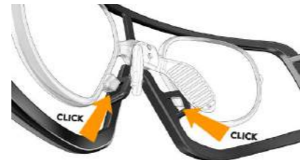
4 premere per agganciare il clip push to assemble the clip
