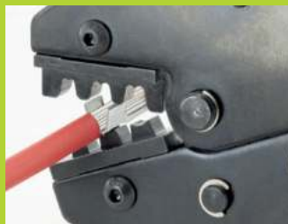
Abisoliertes Kabelende zusammen mit der Kontakthülse in Crimpzange einlegen.
