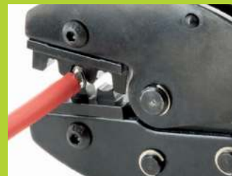
Crimpzange kraftvoll zusammendrücken.
