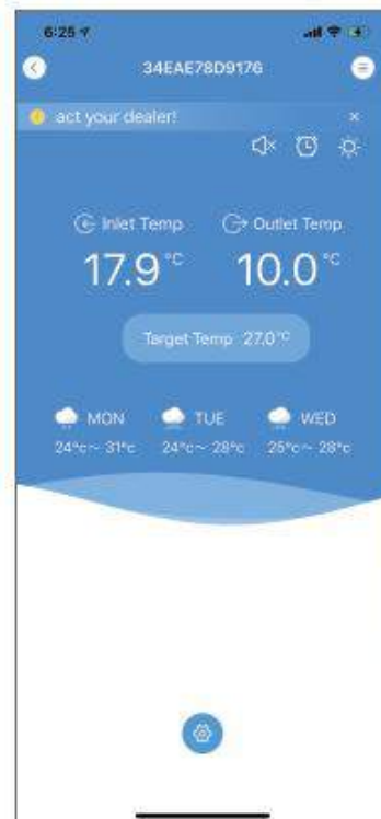
Abb.20 Hauptschnittstelle des Geräts
