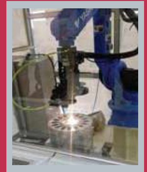
Συγκόλληση λέβητα με τεχνολογία λέιζερ
