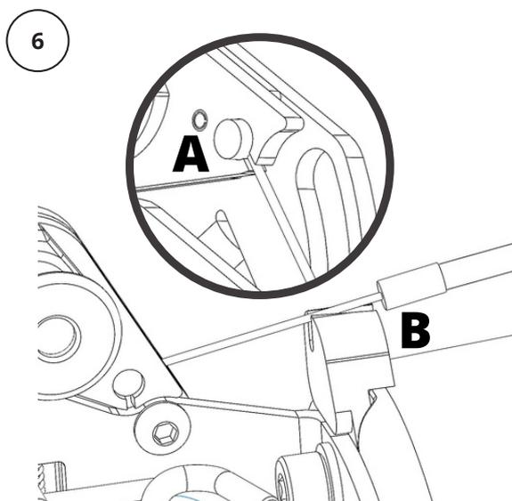
Installer le câble d'accélérateur et le régler si nécessaire
