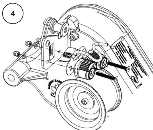
Installez le système de taquet récupéré à l'étape 1 avec les nouveaux boulons de 5 mm et les écrous borgnes.
