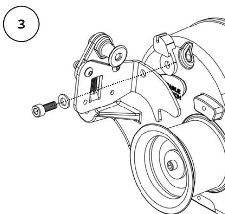
Installer le nouvel ensemble avec le support de câble en utilisant la clé hexagonale de 6 mm
