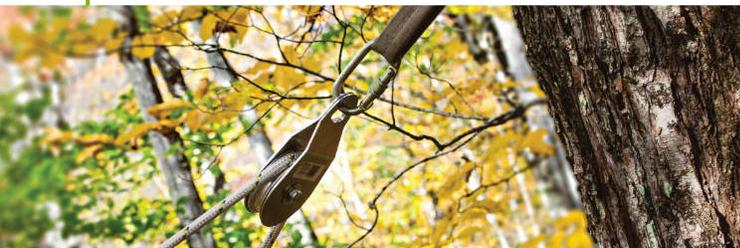
En général, chaque poulie doit être fixée à un point d'ancrage solide à l'aide d'un mousqueton et d'une élingue, en respectant le facteur de sécurité approprié. Par conséquent, pour chacune des poulies, un mousqueton de capacité suffisante et une élingue sont nécessaires.
