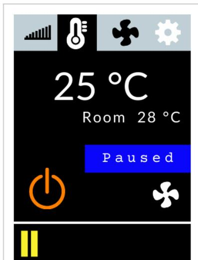
Wenn sich das Heizgerät im Pause-Modus befindet, erscheint im Display der Text *Paused*. Das Heizgerät beginnt automatisch wieder zu heizen, wenn die Raumtemperatur 2 °C unter die eingestellte Solltemperatur fällt.
