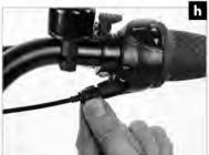
Kontrollieren Sie erneut, ob die Markierungslinien noch aufeinander ausgerichtet sind. Gegebenenfalls müssen Sie die Einstellung nochmals leicht korrigieren. Drehen Sie dazu erneut die Zugeinstellschraube am Schaltgriff schrittweise so weit im oder gegen den Uhrzeigersinn, bis die Markierungslinien deckungsgleich ausgerichtet sind.
