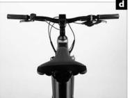
Lassen Sie Ihr Pedelec aus geringer Höhe auf den Boden springen. Gehen Sie auftretenden Klappergeräuschen nach. Prüfen Sie ggf. Lager, Schraubverbindungen und den korrekten Sitz des Akkus und der Stecker (e+f). Drehen Sie ggf. lose Schraubverbindungen etwas an.
