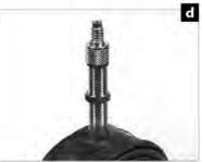
**Prestaventile** können Sie mit speziellem Adapteraufsatz an der Tankstelle mit dem Pressluft-Spender füllen. Betätigen Sie den Luftspender in kurzen Stößen, da sonst zu viel Luft in Ihren Reifen gelangen und dieser platzen könnte.
