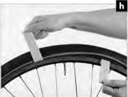
Wenn Sie den Reifen demontiert haben, sollten Sie das Felgenband untersuchen (a). Es sollte gleichmäßig sitzen, darf nicht beschädigt oder rissig sein und muss alle Speichennippel und -bohrungen bedecken.
