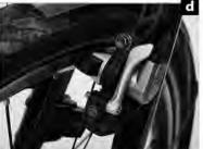
Die Bremsbeläge müssen gleichzeitig und parallel (a) auf die Felge treffen. Diese Einstellung soll vermeiden, dass die Beläge quietschen.
