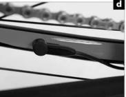
6. Sind die Reifen in gutem Zustand und haben beide Reifen genügend Druck (e)? Beachten Sie, dass ein Pedelec schwerer ist und Ihr gewohnter bisheriger Reifendruck zu gering sein kann. Ein höherer Druck ergibt eine bessere Fahrstabilität und erhöht die Pannensicherheit. Die Angaben über Mindest- und Maximaldruck (in bar oder PSI) finden Sie seitlich auf der Reifenflanke.
