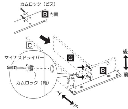
5. 天板【F】内側の下穴にカムロック(ビス)を2箇所取付、仕切り板【G】側面の下穴と組合せ、横からマイナスドライバーを使い、カムロック(軸)を2箇所取付ける。
