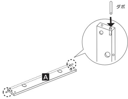
2. 底板【B】の下穴にカムロック(ビス)を2箇所取付、底補強板(前)【A】の下穴と組合せる。底補強板(前)【A】の下穴に、マイナスドライバーを使い、カムロック(軸)を2箇所取付ける。
