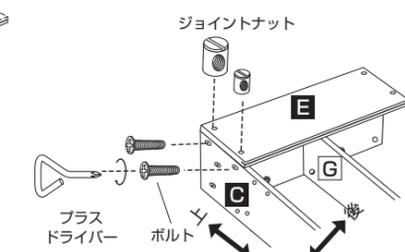
11. 本体の左側板【C】が地面になるように回転させる。背板【H】を【E】【D】のスリッドに沿って上からスライドする。
