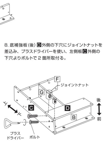
8. 底補強板(後)【D】外側の下穴にジョイントナットを差込み、プラスドライバーを使い、左側板【C】外側の下穴よりボルトで2箇所取付ける。
