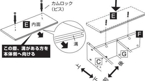
10. 後板【E】の下穴にジョイントナットを差込み、プラスドライバーを使い、左側板【C】外側の下穴よりボルトで2箇所取付ける。
