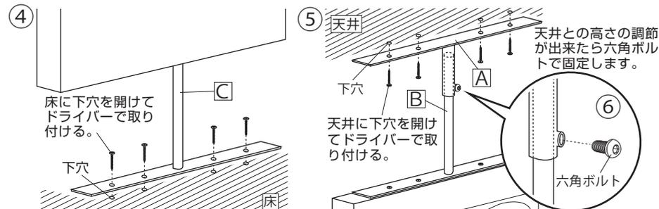
※床がコンクリートの場合はコンクリートアンカー、コンクリートビスをご使用下さい。
