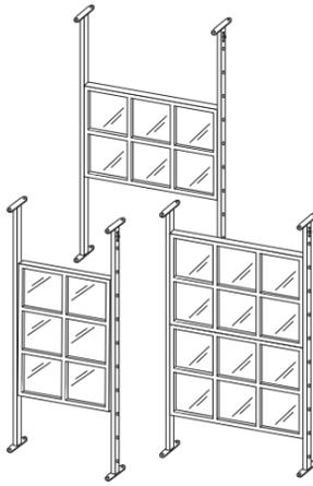
重量：パネル 17.9kg、鉄柱(1本) 6kg
