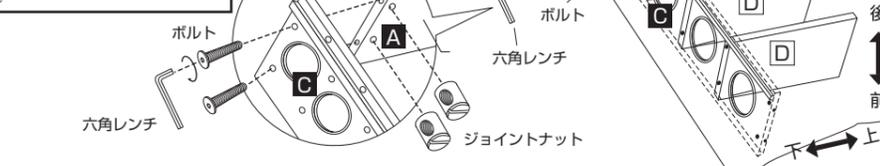
9. 補強板F(下) 外側の下穴に、ジョイントナットを5箇所差込み、六角レンチを使い、底板C外側の下穴よりボルトを3箇所取付ける。右側板A、左側板B外側の下穴よりボルトをそれぞれ1箇所ずつ取付ける。
