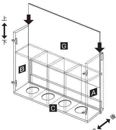
11. 本体を立てて、背板GをA Bのスリッドに沿って上からスライドし、底板Cの溝に最後まで差込む。
