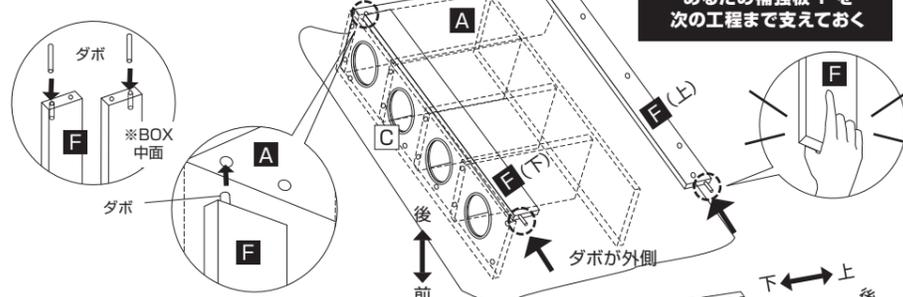
この際、破損の可能性があるので補強板Fを次の工程まで支えておく
