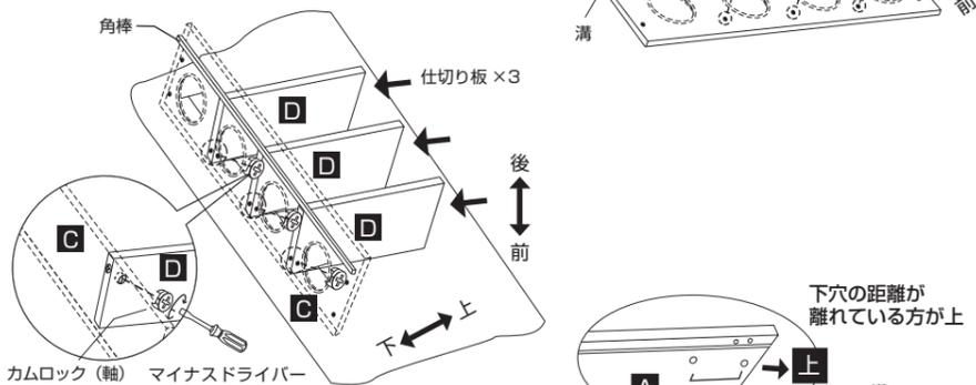
3. 右側板Aの丁番を折りたたみ、上下を確認し溝が上になるように底板Cと合せ、右側板A内側の下穴にジョイントナットを2箇所差込む。六角レンチを使い底板C外側の下穴よりボルトを2箇所取付ける。
