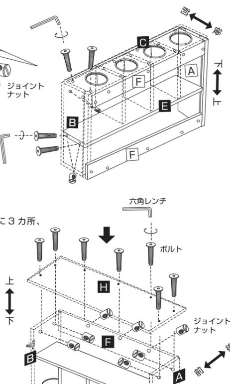
4. 棚板E内側の下穴よりダボとカムロック(ビス)を3カ所取付ける。
