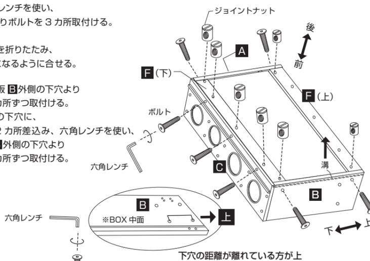
12. 底板Cが上面になるように90度回転させ、左側板B内側と棚板E外側の下穴にジョイントナットを2カ所ずつ差込む。六角レンチを使い、底板C、左側板B外側の下穴よりボルトを2カ所ずつ取付ける。
