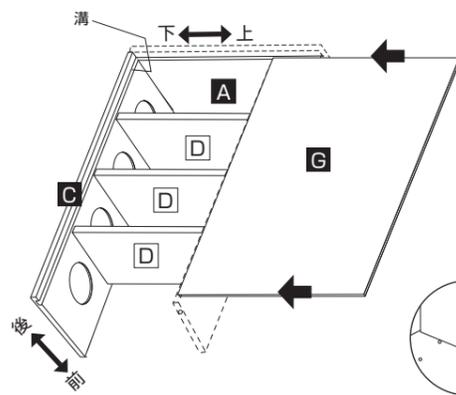
7. 背板Gを右側板Aのスリットに沿って横からスライドし、底板Cの溝に最後まで差込む。
