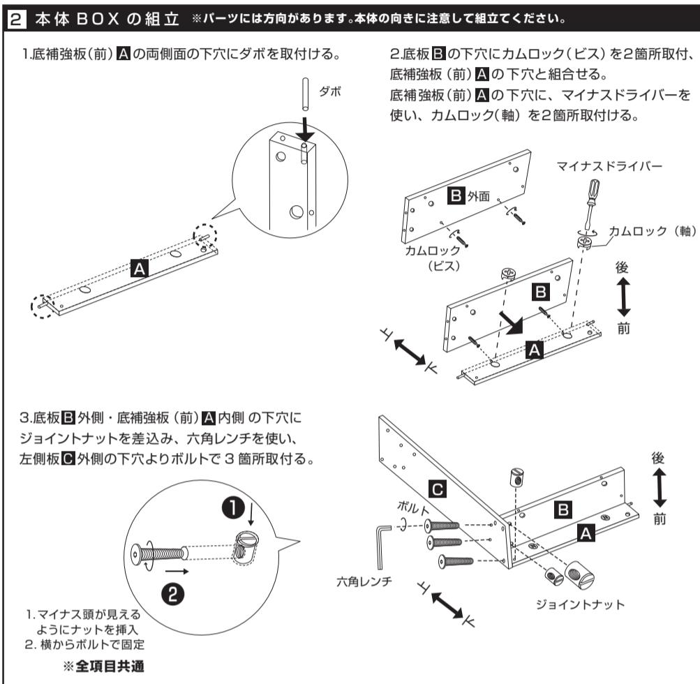
4. 底板B内側の下穴にカムロック(ビス)を2箇所取付、仕切り板G側面の下穴と組合せ、横からマイナスドライバーを使い、カムロック(軸)を2箇所取付る。
