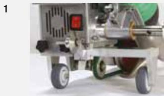
**1** **Niente più riattrezzamenti dispendiosi in termini di tempo:** La saldatrice automatica per tetto con asse di trasporto scorrevole consente di effettuare agevolmente saldature vicino al bordo fino a 100 mm su parete verticale del muro d'attico e sulla superficie corrente e in tutti i punti che presentano una difficile accessibilità.
