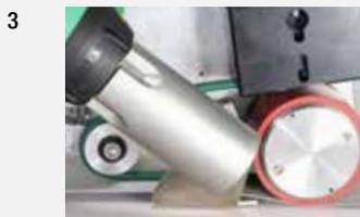
**3** **UNIROOF AT: Il sistema a ciclo chiuso** completamente regolato per sistema di azionamento, temperatura e quantità d'aria della soffiante mantiene costanti i parametri di saldatura, assicura una tenuta affidabile della saldatura, garantendo conseguentemente sicurezza di processo..
