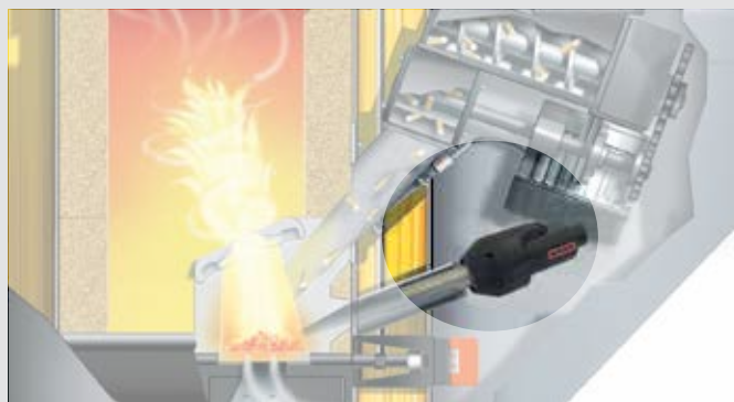
Schema di costruzione tipico di stufa a pellet
