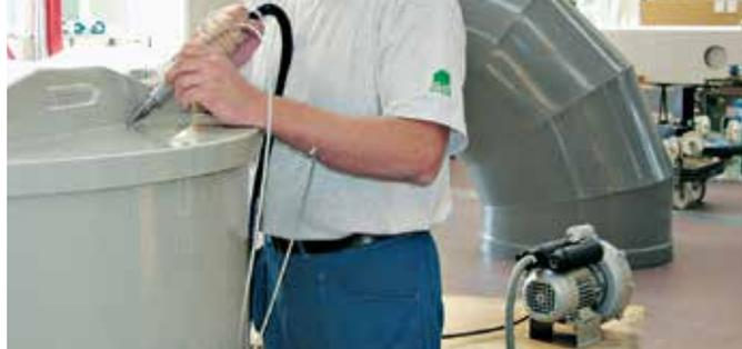
Soffiante ROBUST come alimentazione dell'aria per WELDING PEN.
