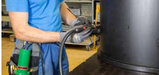
LABOR S abbinato a MINOR come sistema di alimentazione dell'aria.
