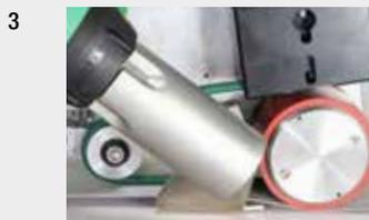
**3** **UNIROOF AT: Il sistema a ciclo chiuso** completamente regolato per velocità di avanzamento, temperatura e quantità d'aria della soffiante mantiene costanti i parametri di saldatura, assicura una tenuta affidabile della saldatura, garantendo conseguentemente sicurezza di processo.
