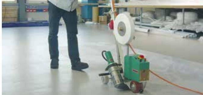
Saldatura in applicazione di nastri a cinghia alla massima velocità.
