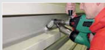
La testina angolare a 45° di WELDPLAST S2 semplifica le operazioni di saldatura nelle posizioni più complesse (accessori).
