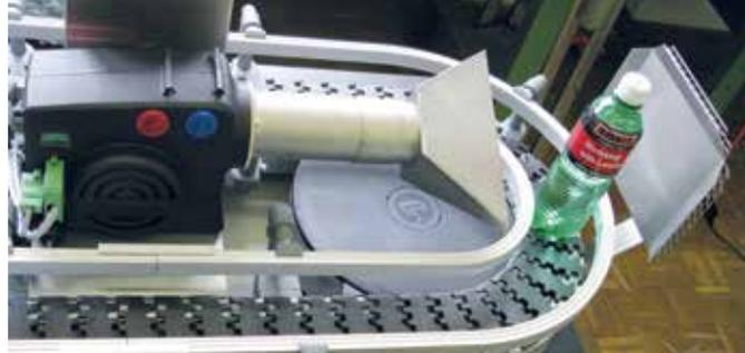
HOTWIND SYSTEM con ugello a slot largo integrato in un'applicazione blow-off.
