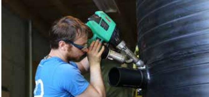
Il maneggevole estrusore WELDPLAST S2 in funzione.
