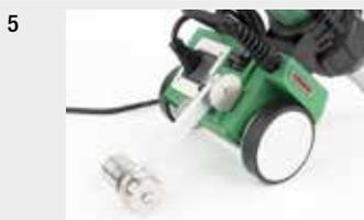
**5** **Sensore di avvio integrato:** con l'avvio ritardato regolabile individualmente nell'unità motrice del MINIFLOOR, è possibile gestire l'avvio dell'apparecchio secondo le proprie esigenze. Il lungo braccio guida garantisce un eccellente mantenimento della traccia.
