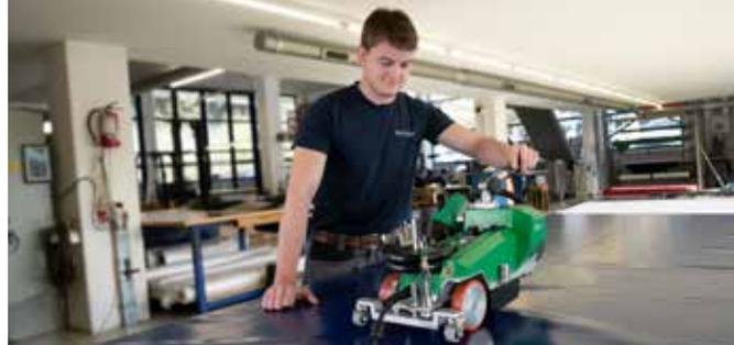
UNIPLAN 300 / UNIPLAN 500: Entrambe le saldatrici automatiche sono ideali per la saldatura a sovrapposizione, a orlatura e di rinforzo. Sia su tavolo che su pavimento.
