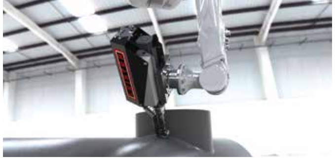
WELDPLAST 200-i / 600-i – Robot per saldatura a estrusione e stampa 3D, concepiti per il funzionamento automatizzato continuo
