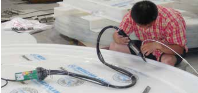
Soffiante MINOR come sistema di alimentazione dell'aria per DIODE PID.
