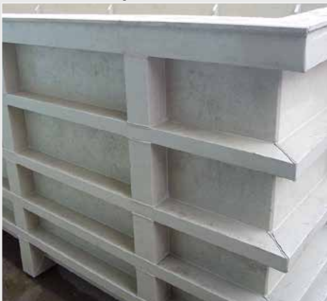
Galvanotecnica serbatoio, Turchia. Materiale: PP
