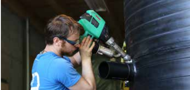
Il maneggevole estrusore WELDPLAST S2 in funzione.
