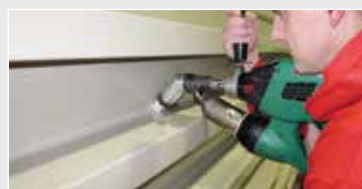
La testina angolare a 45° di WELDPLAST S2 semplifica le operazioni di saldatura nelle posizioni più complesse (accessori).
