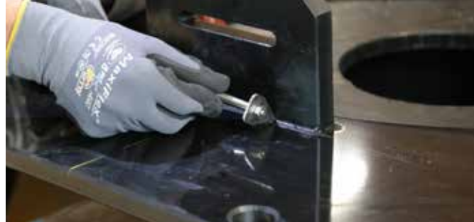
Con il raschiatore di contorno si ottiene una perfetta pre- e post-lavorazione del cordone di saldatura.
