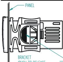
Le XR60CX se monte en façade dans une découpe de 29x71 mm et se fixe à l'aide des pattes spéciales qui sont fournies. La gamme de température autorisée pour un fonctionnement correct de l'appareil est de 0 ÷ 60°C. Ne pas l'installer dans un endroit soumis à de fortes vibrations, à des gaz corrosifs, à des poussières ou une humidité excessives. Les mêmes recommandations s'appliquent aux sondes. Laisser l'air circuler autour des fentes d'aération.
