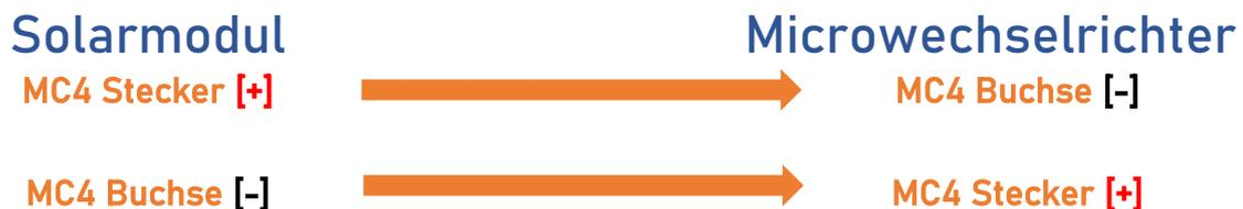
An jeder Seite des HM-1500 befinden sich die Anschlüsse für je zwei PV Module. Die jeweiligen rot umkreisten MC 4 Stecker sind für den Anschluss eines PV Moduls vorgesehen. Verbinden Sie die Module nicht Kreuzweise
