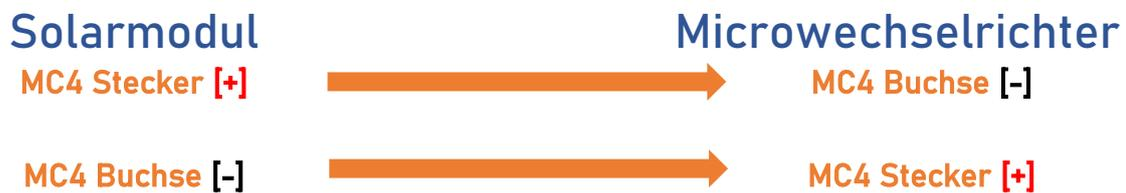
Die MC4 Anschlüsse des Wechselrichters haben wir farblich markiert. An den Solarmodulen finden Sie an den MC4 Steckern die gleichen Farben. Verbinden Sie die passenden Farben miteinander. Stecken Sie die MC4 Verbinder vollständig ineinander. Der richtige Anschluss wird durch einen „Klick“ quittiert.
