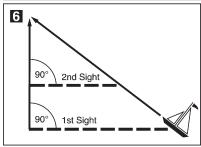
物体の観測。楽な姿勢で両手を使って、黄色のカーソルの線を自分の方に 向けてコンパスを持ちます。両方の指針が見えるようにコンパスを少し傾 け、両方の指針が観測しようとする物体と同一線上に重なるまで、手と上 半身を回転させます(図1)黄色のカーソル線上の方角を読みます。注 意:大きな金属製の物体の近くに立つと磁石が影響を受けるため、正確 が損なわれます。
