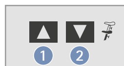
Abbildung 6-4: Sattelverstellung am Bedienkopf 1 Sattelhöhe erhöhen 2 Sattelhöhe reduzieren
