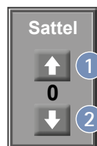
Abbildung 6-5: Sattelverstellung am Display 1 Sattelhöhe erhöhen 2 Sattelhöhe reduzieren
