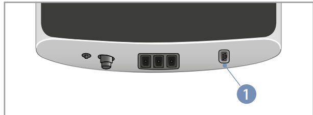
Abbildung 4 – 15: Anschluss Sauerstoffsättigung 1 SpO2-Anschluss
