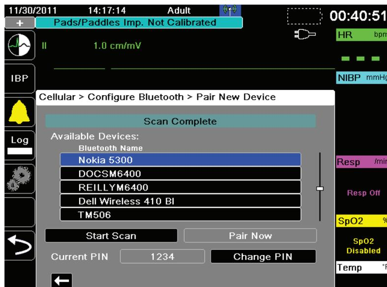
Wählen Sie "**Jetzt koppeln**", um das Gerät zu koppeln. Anschließend kehrt das Gerät zur Liste der gekoppelten Geräte zurück.
