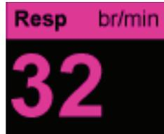
Die Atemfrequenzanzeige zeigt die Atemfrequenz an, die standardmäßig aus der CO<sub>2</sub>-Überwachungsfunktion des Geräts abgeleitet wurde. Wenn keine CO<sub>2</sub>-Überwachung verfügbar ist, leitet das Gerät die Atemfrequenz mittels einer vorgegebenen EKG-Elektrodenkonfiguration über *Impedanzpneumografie* ab. Bei nicht funktionierender EKG-Überwachung zeigt die **Resp/BR**-Anzeige auch keine Atemfrequenz an.
