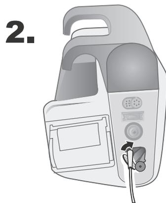
**Abbildung 9-1 Anschließen des Messleitungsanschlusses am CO<sub>2</sub>-Einlass**
