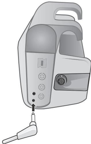
**Abbildung 12-1** Anschließen der Temperatursonde an das X Series Gerät
