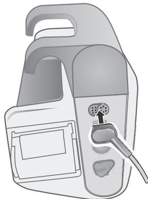
**Abbildung 14-2** Anschließen des 12-Kanal-EKG-Kabels
