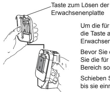
Um die für Kinder geeignete Platte freizulegen, drücken Sie die Taste an der Unterseite der Paddles und ziehen die Erwachsenenplatte nach oben ab.
