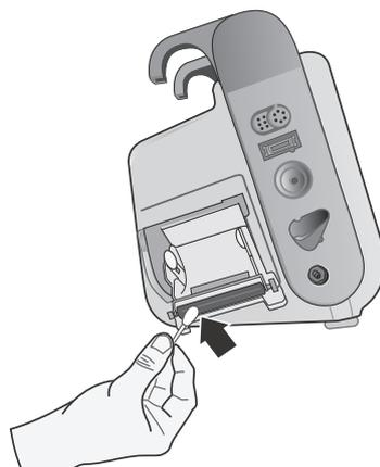
**Abbildung 24-3. Reinigen des Druckkopfs**
