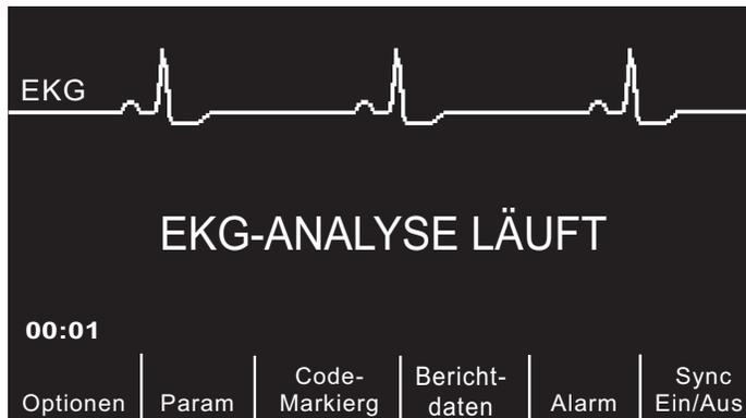
Die Meldung *EKG-ANALYSE LÄUFT* wird für ca. 6 bis 12 Sekunden angezeigt, während das EKG des Patienten analysiert wird. Sobald die Analyse abgeschlossen ist, zeigt das Gerät an, ob ein Schock verabreicht werden sollte oder nicht.
