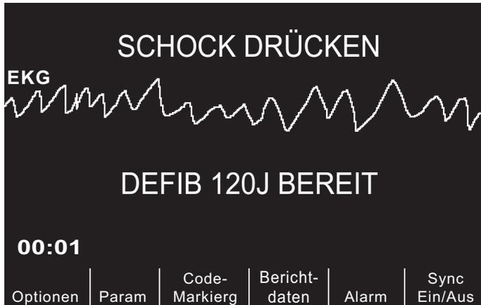
50 Sekunden lang ist ein Dauerton zu hören. Dann folgt 10 Sekunden lang eine Signalsequenz. Verabreichen Sie den Schock innerhalb dieser insgesamt 60 Sekunden, sonst entlädt sich der Defibrillator selbsttätig.
