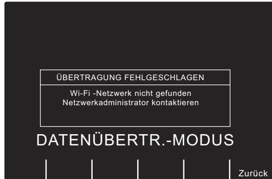
Um den Wi-Fi-/Datenübertragungsmodus zu verlassen, drücken Sie die Funktionstaste **Zurück** und anschließend die Funktionstaste **Übertrag beenden**, oder drehen Sie den Moduswählschalter auf **AUS**.
