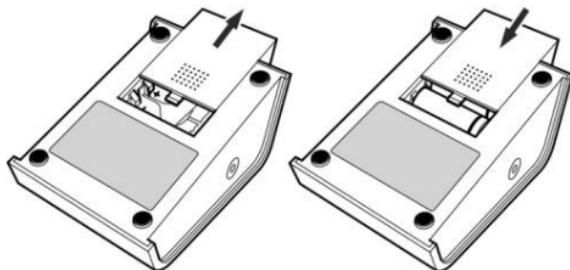
Abb. 4: Batterieabdeckung öffnen
