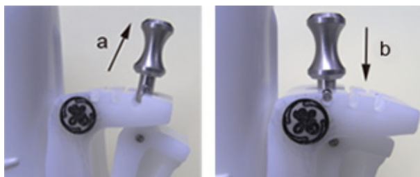
Abbildung 5-11. Griff herausziehen und hineindrücken.
