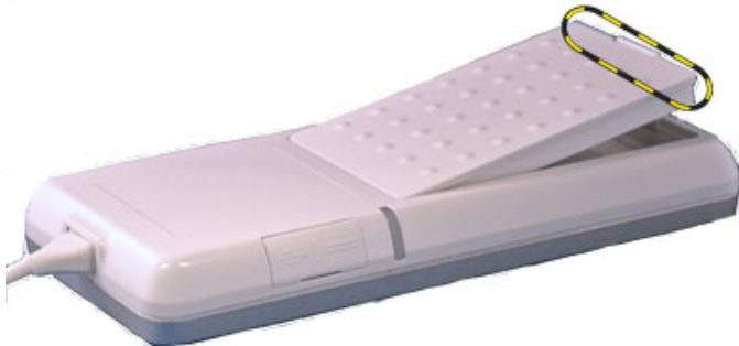
Abbildung 3-20. Entnehmen des Akkus
