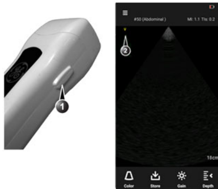
Abbildung 5-1. Ausrichtung der Sektorsonde
