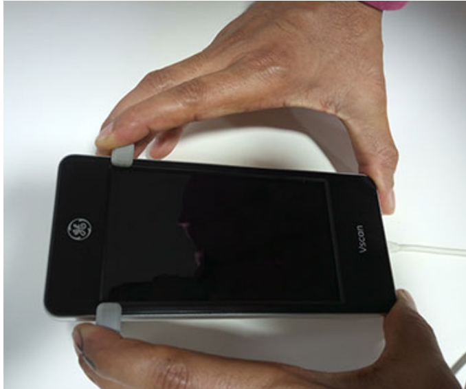
Abbildung 3-8. Untersatz auf Gerät schieben
