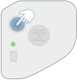
Zum Einschalten berühren Sie einfach die seitlich angebrachte Touchfläche. Das Gerät schaltet mit einem Signalton ein und die grüne LED (Betriebsanzeige) leuchtet. Ausschalten erfolgt automatisch bei Nichtbenutzung nach 5min. Ein Signalton kündigt das Ausschalten an. Die grüne LED erlischt.
