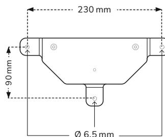
Nutzen Sie das beiliegende Montageset zur Befestigung. Achten Sie darauf, dass der Untergrund plan und tragfähig ist. Richten Sie die Wandmontagehalterung in Waage aus und befestigen Sie alle 3 Montagepunkte. Die Montagehöhe wählen Sie gemäß der mittleren Körpergröße der Nutzer aus, so dass das Gerät bequem bedient werden kann.
