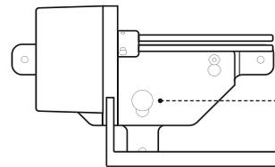
Trennen Sie bitte die Wandmontagehalterung durch Lösen und Entfernen der Rändelschraube vom Gerät.
