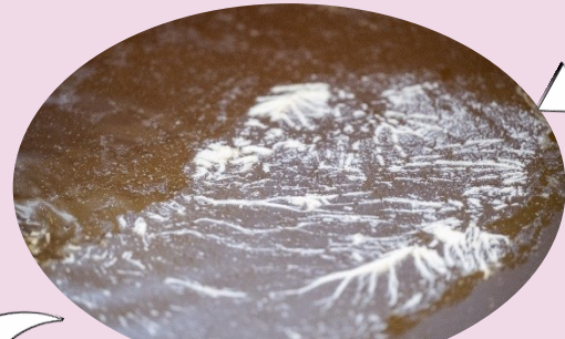
⑨ 静置発酵室内のタンクに移して、創業以来守り続けている、種酢と天然水、酢酸菌を加えて約2~3か月発酵させます。
