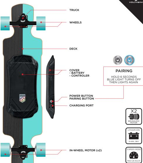
• DOUBLE IN-WHEEL MOTOR: 400W • MAX. LOAD: 100Kg
