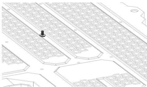
Rondelle combinée en caoutchouc [côté caoutchouc contre le dessus du panneau DECKED]
