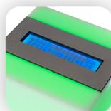
El medidor en color verde le indica que los niveles de CO2 no superan los 750 ppm, con una calidad del aire **óptima**.
