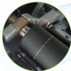
Bei Verschleiß der Druckplattenwalze beginnt die weiße Linie zu verblassen.
