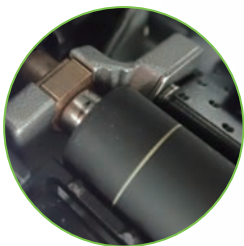
Weißer Linie auf einer neuen PureLine™-Druckplattenwalze.
