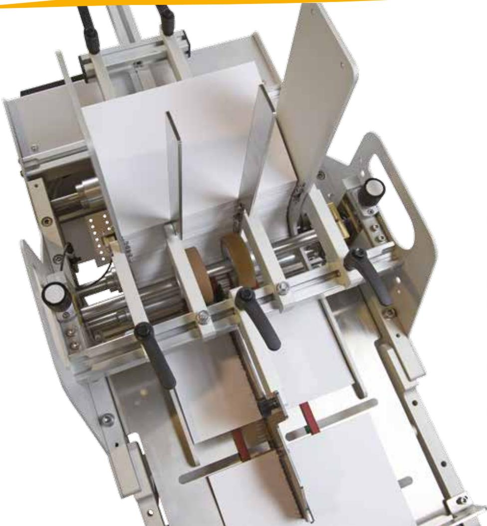
Die Auswahl des zu beschickenden Produktes erfolgt über Gummirollen, die gegenläufig arbeiten. Das System ist sowohl auf der rechten als auch auf der linken Seite mit Mikroreglern ausgestattet, wodurch es bei allen Produkttypen, die verwendet werden sollen, ausgesprochen flexibel ist. Das geräumige Lager mit einer Höhe von 300 Millimetern ist mit einer Kontrolle für die Mindestbefüllung ausgestattet und garantiert eine große Autonomie im Betrieb.
