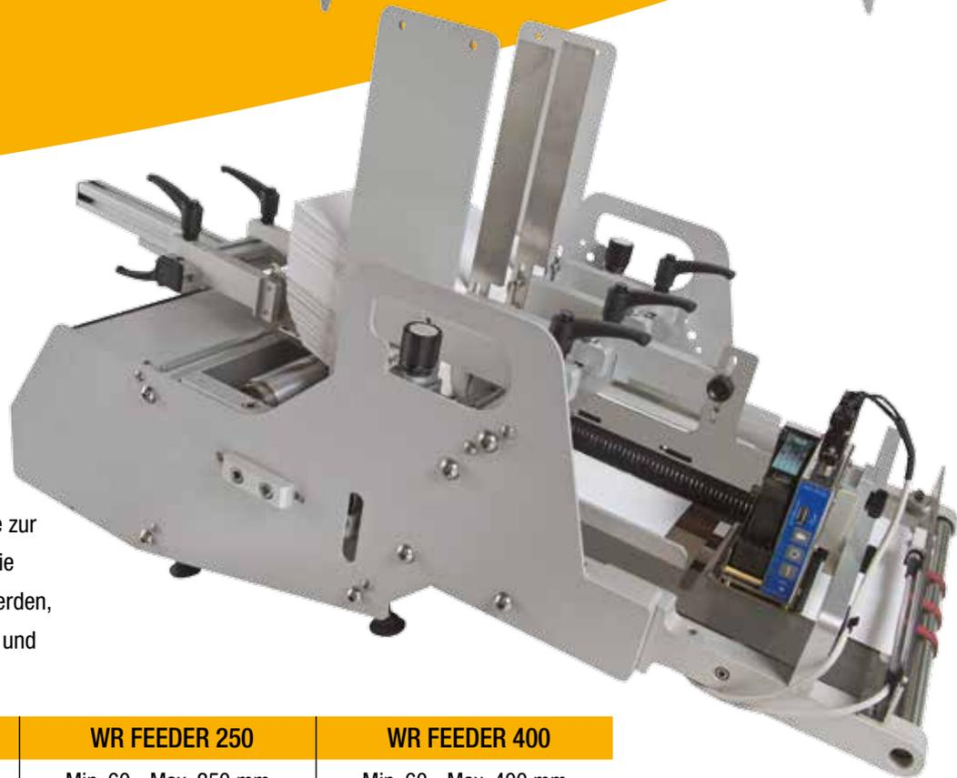
WR FEEDER kann mit einem Tintenstrahlmarkierer mit HP-Technologie zur Beschriftung mit verschiedenen Texten wie Datum, Uhrzeit, Barcodes ausgestattet werden, wobei eine maximale Höhe von 12,7 mm und eine Auflösung von 300 dpi möglich sind.
