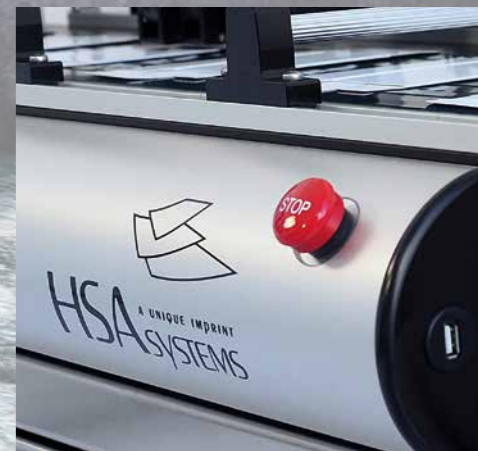
Not-Halt rechts vorne an der Maschine.
