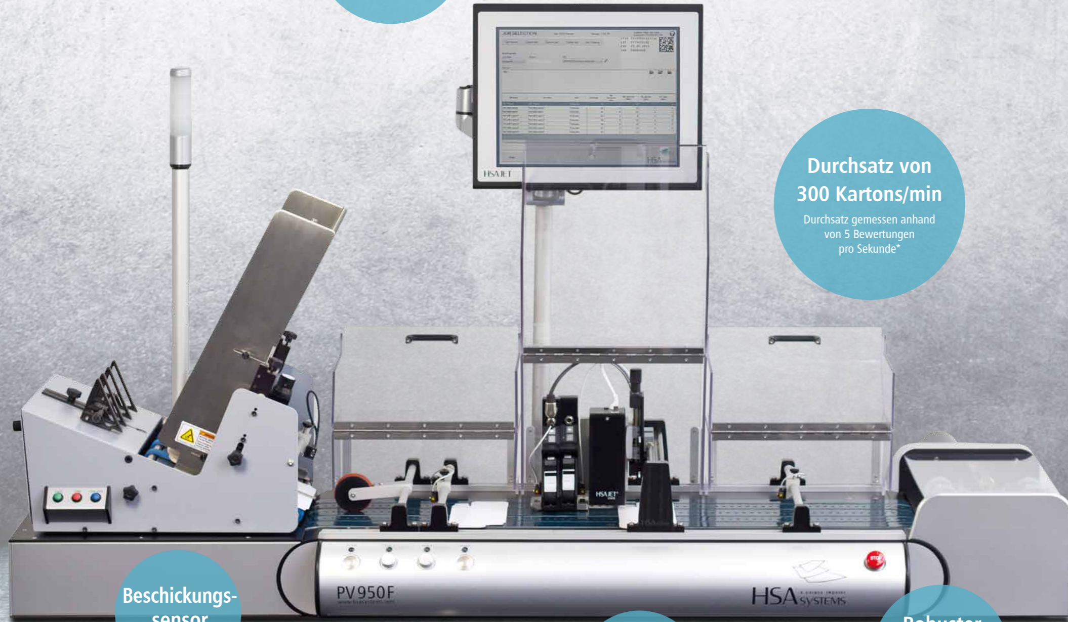
Kamera und Druckkopf befinden sich auf einer gemeinsamen in der Höhe und über das Band verstellbaren Halterung.
