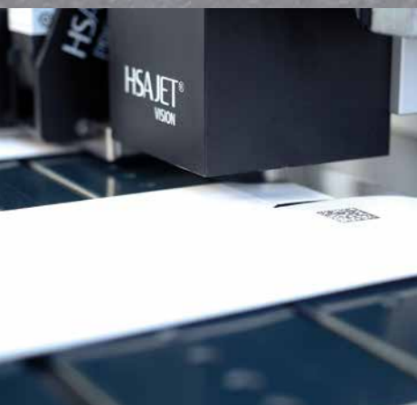
Optische Prüfkamera für Codeverifizierung und -bewertung.
