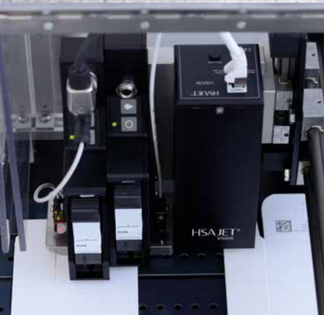
Kamera und Druckkopf befinden sich auf einer gemeinsamen in der Höhe und über das Band verstellbaren Halterung.
