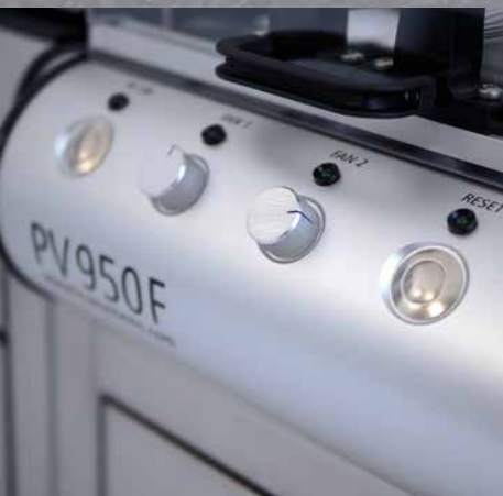
Taster und Regler für das Einschalten des PCs, Not-Halt, Reset und Lüfter befinden sich auf der Vorderseite.
