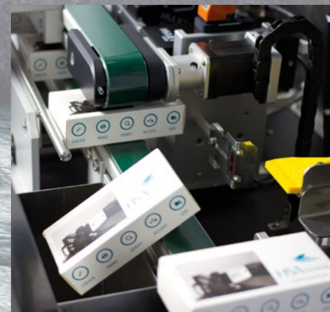
Das Auswurfgebläse. Fehlerhafte Schachteln werden direkt in den Auffangbehälter geleitet.
