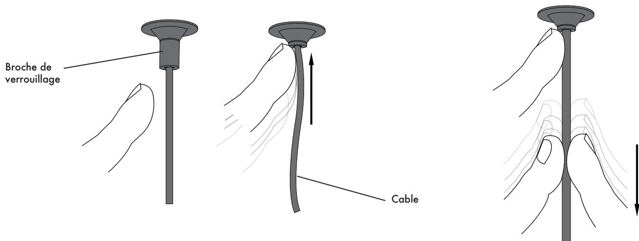
**La longueur du câble est réglable. Pour déterminer la longueur appropriée du luminaire, maintenez la canopée du luminaire contre le boîtier de dérivation au plafond pour ajuster le câble.**
