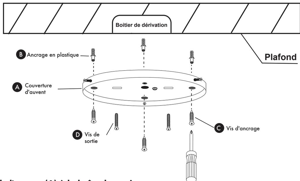
**Fixez le couvercle de l'auvent (A) à la boîte de sortie avec les vis de sortie (ET). Vissez les vis d'ancrage (C) dans les ancrages en plastique (B) pour fixer la couverture de l'auvent (A).**
