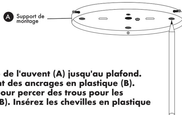
**Soulevez la couverture de l'auvent (A) jusqu'au plafond. Marquez l'emplacement des ancrages en plastique (B). Utilisez une perceuse pour percer des trous pour les chevilles en plastique (B). Insérez les chevilles en plastique (B) dans le trou.**
