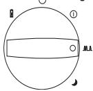
L'électrificateur est en mode de puissance réduite. Ce mode est recommandé pour les clôtures plus courtes afin de prolonger la durée de vie de la batterie.
