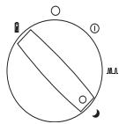
El Energizador se ajusta automáticamente a un pulsado más lento al acercarse la noche utilizando la detección de intensidad de luz. Ahorro nocturno extenderá la vida de la batería hasta un 50%. Adecuado para animales que no son muy activos de noche.
