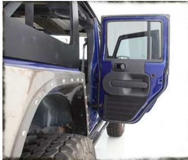
Door Gear Panels
