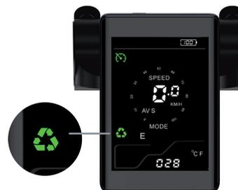
La consommation d'énergie est idéale. La puissance maximale est inférieure à 80% de la capacité lorsque la vitesse est inférieure à 10 km/h. La puissance maximale est inférieure à 20% de la capacité lorsque la vitesse est supérieure à 10 km/h)
