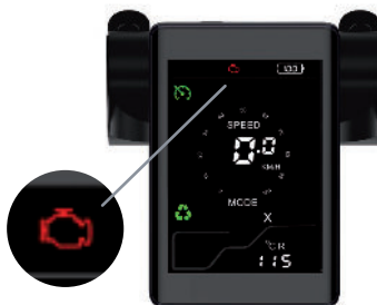
El motor ha alcanzado el límite de protección contra sobrecalentamiento
