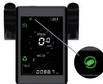
Se puede utilizar el puerto USB del salpicadero y no se puede cambiar el modo de conducción
