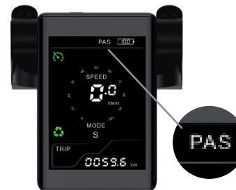
El patinete está en modo de arranque asistido, lo que significa que necesitas aumentar algo de velocidad en el arranque para activar el acelerador.
