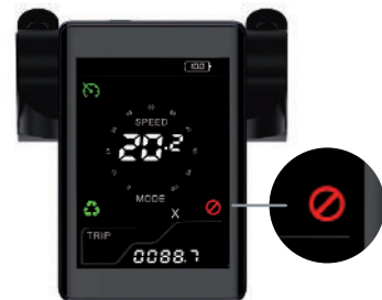
El código de error está activo, el valor aparecerá en la sección A
