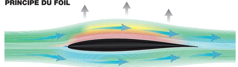
Les ailes avant et arrière fonctionnent comme des plans porteurs, c'est-à-dire qu'elles créent une force de portance au contact de l'eau qui s'écoule autour d'elles avec de la vitesse. C'est la raison pour laquelle les ailes reçoivent un profil spécifiquement étudié.
