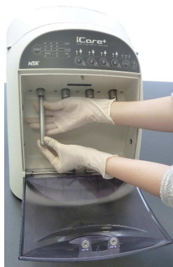
Fig.15 – Visser la bague de maintien
